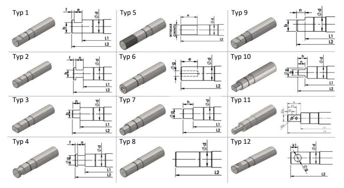
f – Breite der Kante; n - Frästiefe; b- Fräsbreite; h – die Tiefe der Aussparung; e - Gewindelänge / Lochtiefe; φp – Durchmesser der Aussparung; φg – Lochdurchmesser; k1, k2, ..., kn – Der Abstand der Löcher von der Kante; M – Gewindegröße
